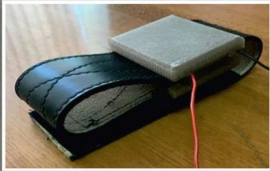
Эффективным техническим средством для остановки кровотечения методом локального замораживания является термоэлектрическое устройство специальной конструкции, дающее возможность обеспечивать высокую интенсивность охлаждения, сокращая продолжительность образования тромба, прекращающего кровоток, реверс тока, что дает возможность устранить болезненные ощущения при съеме прибора с поврежденного участка.
